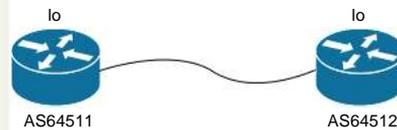
Outro aspecto que se deve destacar em relação à utilização da interface *loopback* é o de trabalhar com uma *loopback* por função e não uma única *loopback* por roteador. Por exemplo, pode-se configurar uma *loopback* para o Router ID, uma para o iBGP e uma para o eBGP.
